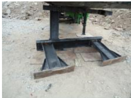
شکل 6. (a) تکیه گاه سرهم بندی شده برای کامیون ؛ (b) قطعه فلزی که روی کارگر افتاد.
