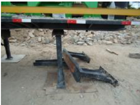
شکل 6. (a) تکیه گاه سرهم بندی شده برای کامیون ؛ (b) قطعه فلزی که روی کارگر افتاد.
