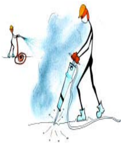
شکل ۱- استفاده از اسپری آب برای مرطوب نگه داشتن جبهه کار معدنی
