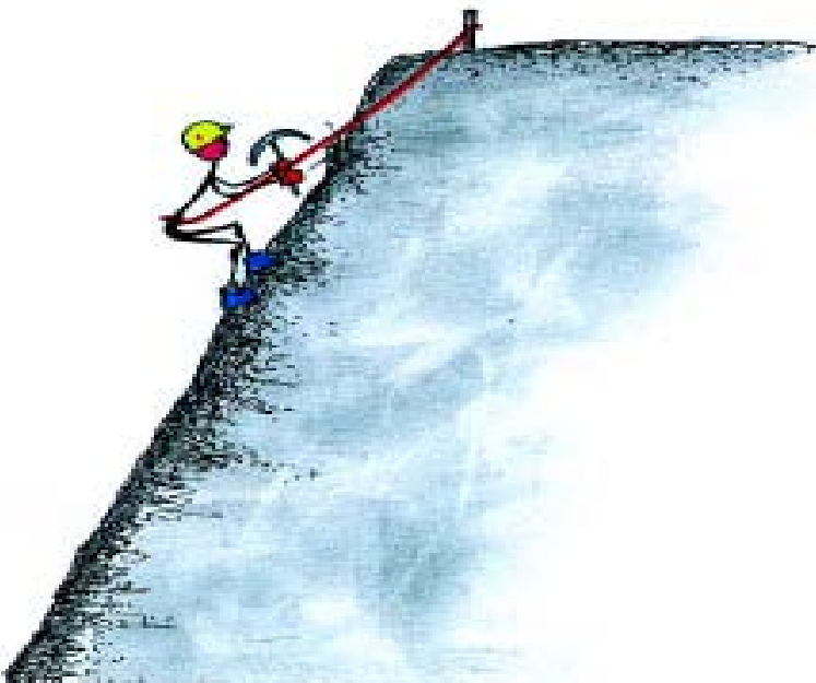
شکل ۲۱- تجهیز کارگر به تجهیزات حفاظت فردی کار در ارتفاع
